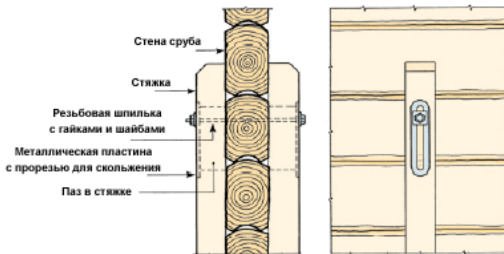
Рис. 6.6.2. Установка стяжек
